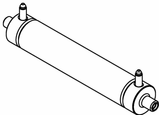
1. Предохранить резьбы M12x1,25 от сварки. На резьбовых поверхностях не допускаются напыльы, капли от сварки.
