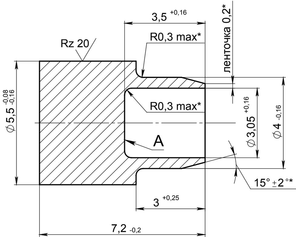
1. \*Размеры обеспечить инструментом.
