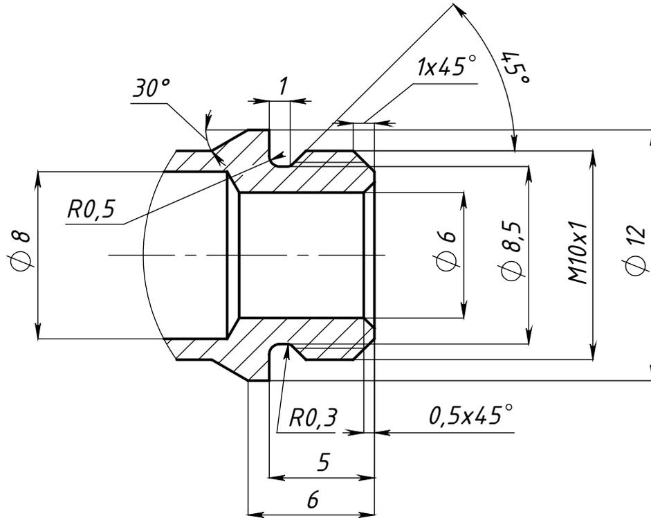
1. Общие допуски линейных размеров по ГОСТ 30893.1: H14, h14,  $\pm IT14/2$ ; угловых размеров - по ГОСТ 30893.1 - т.
