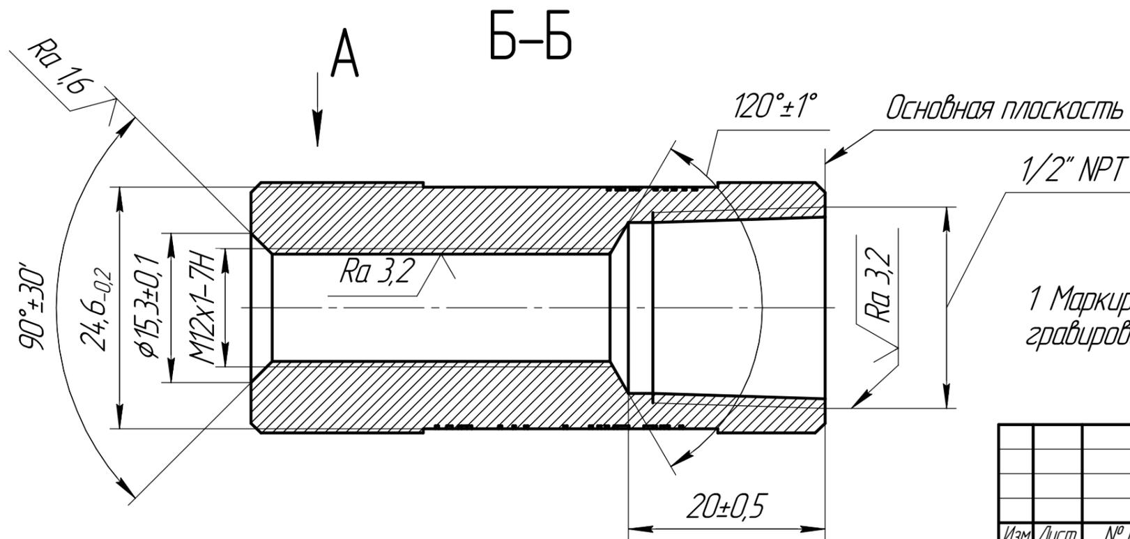
1 Маркировку выполнить согласно чертежа методом лазерного гравирования. Высота шрифта 2,5 мм.
