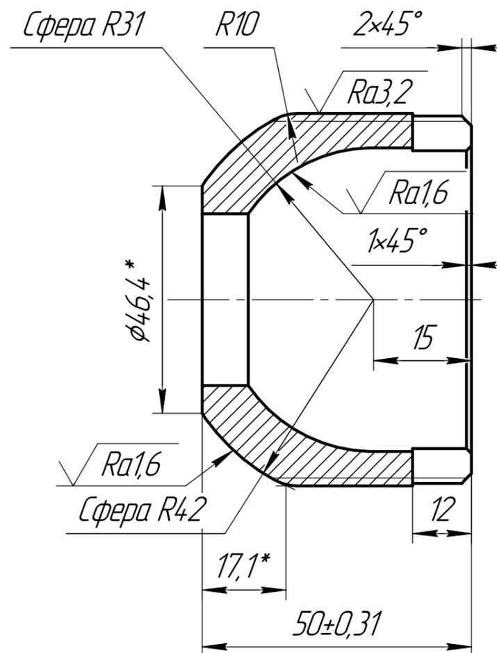
Вариант исполнения внутренней поверхности ЗКФ-КМЗ-600-10.03.00.01-01
