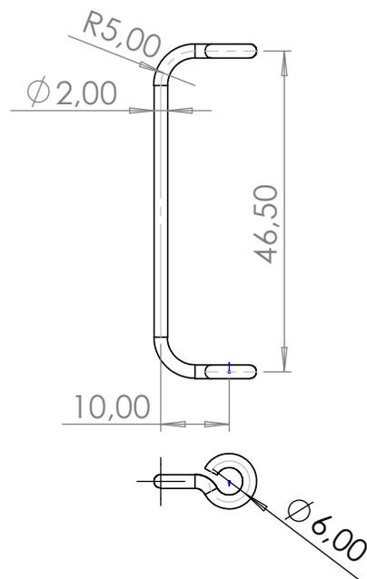
В случае применения платы толщиной 2мм уменьшить длину на 0.5мм
