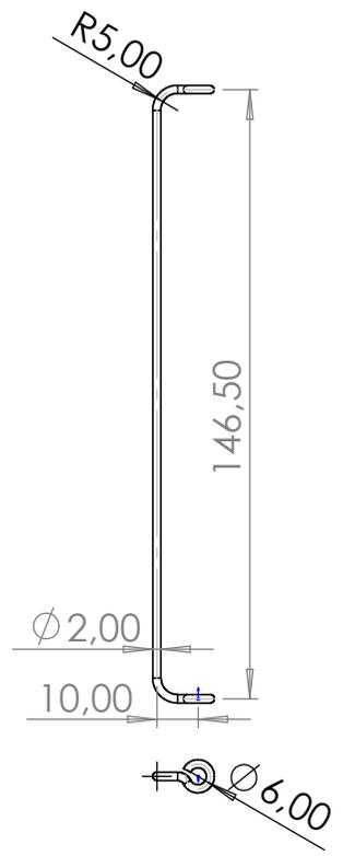
В случае применения платы толщиной 2мм уменьшить длину на 0.5мм
