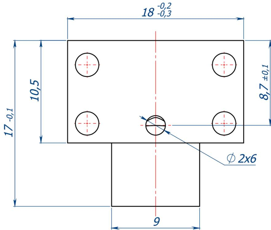
4 отв.  $\phi 2,4/\phi 4,4 \times 90^\circ$
