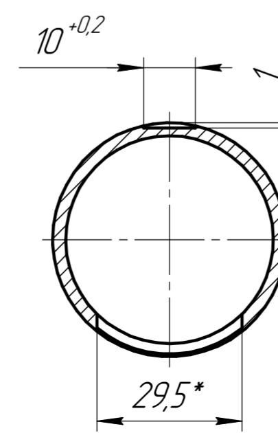
1 Материал: труба стальная ГОСТ 3262-75 ( $D_y=40\text{мм}$ ,  $D_H=45\text{мм}$ ).2 Общие допуски по ГОСТ 30893.1-2002:  $H14$ ;  $h14$ ;  $\pm \frac{IT14}{2}$ .3 Внешние острые кромки притупить фаской  $0,2 \times 45^\circ$ .
