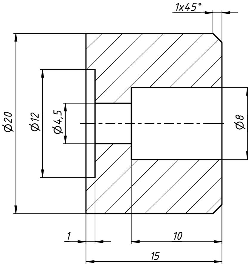
1. Допускается изготовление из материала близкого по своим физико-механическим свойствам к материалу указанному в чертеже.
