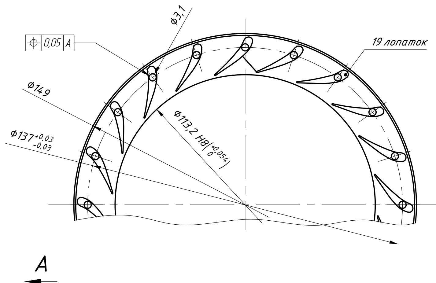
1. Предельные отклонения на угловой шаг и любую сумму угловых шагов лопаток  $\pm 5'$
