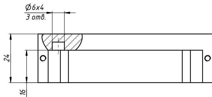
\* – неуказанные предельные отклонения размеров  $\pm 0,1$  мм
