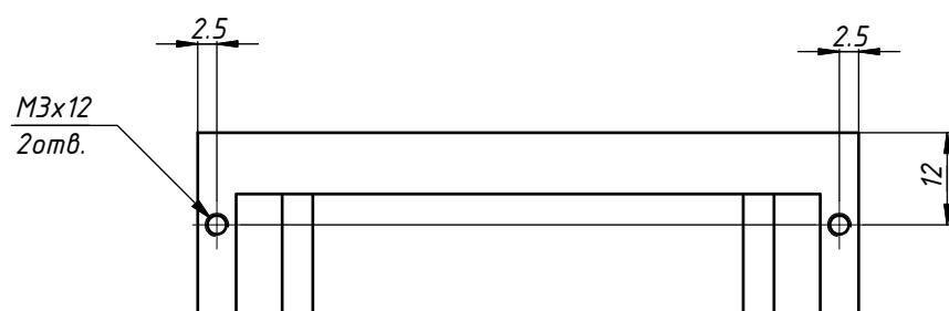
\* - неуказанные предельные отклонения размеров  $\pm 0,1$  мм
