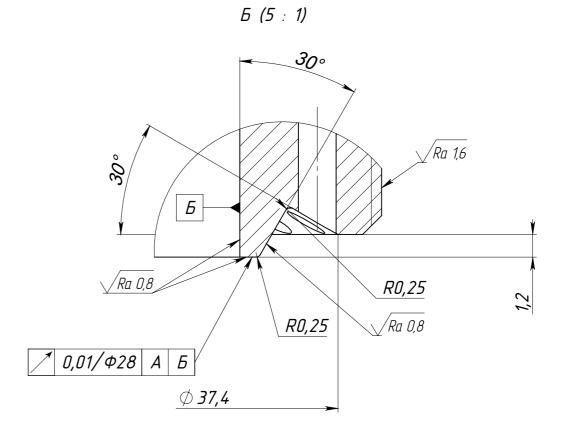
1. \* - Размеры для справок. 2. Неуказанные фаски и радиусы скруглений 0,25 мм 3. H12; h12; IT12/2. 4. Материал пробного образца AISI304
