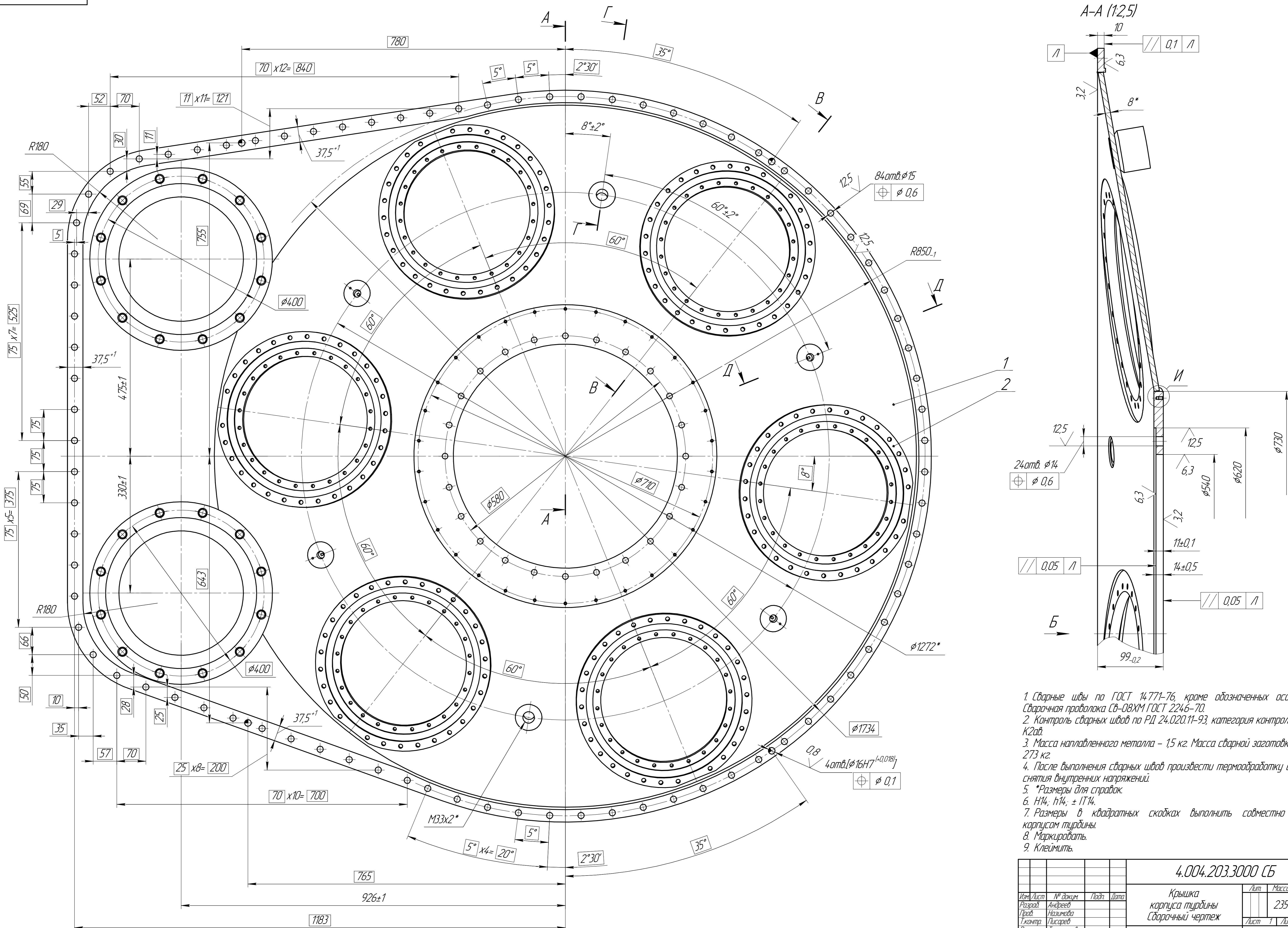
1. Сварные швы по ГОСТ 14771-76, кроме обозначенных особы. Сварочная проволока Св-08ХМ ГОСТ 2246-70.
