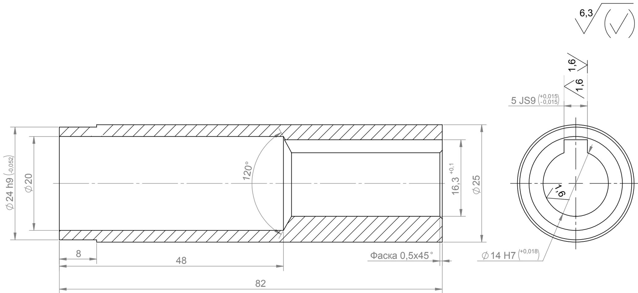
1 Неуказанные предельные отклонения размеров, формы и расположения поверхностей - по 12 качеству.
