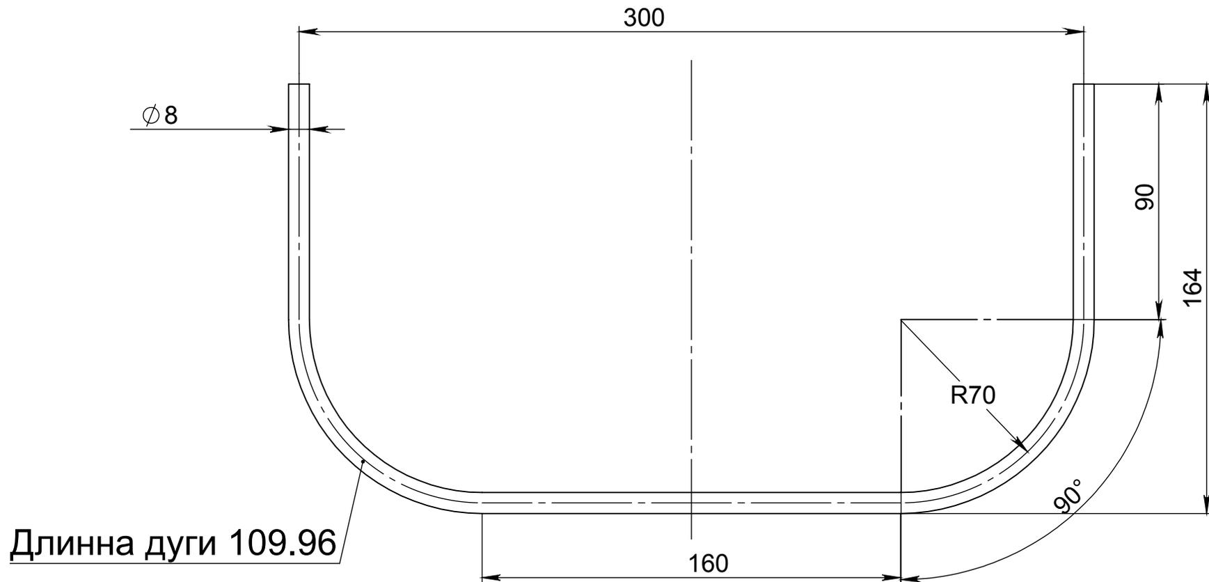
Мне нужны две максимально одинаковые скобы в плане посадочного размера 300мм и размеров 160, R70. Размеры 90 и 164 не критичны могут быть выполнены почти с любым допуском в + или макс -10 мм. Радиусы должны быть без заломов деформаций. Так как изделия будет использоваться в качестве направляющих для одной каретки, поэтому нужна максимальная идентичность обеих скоб.
